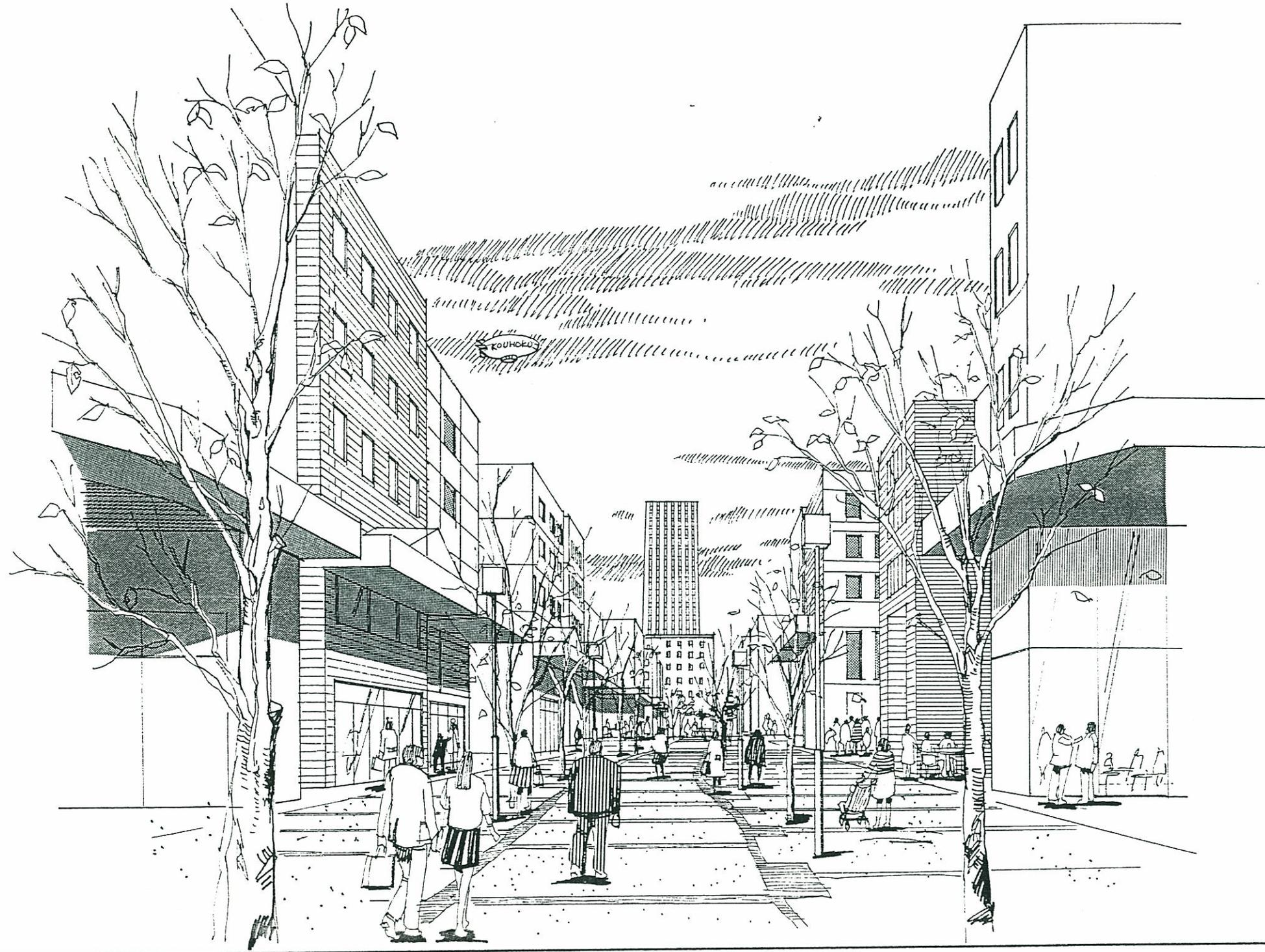
④ 第2地区 シンボル道路B 整備イメージ図 (シンボル広場から下る階段の途中から地域体育館方向を見る。左側にペデデッキが飛び、階段とエレベーターがデッキとシンボル道路のレベルをつなぐ。)
