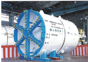
シールド掘進機
